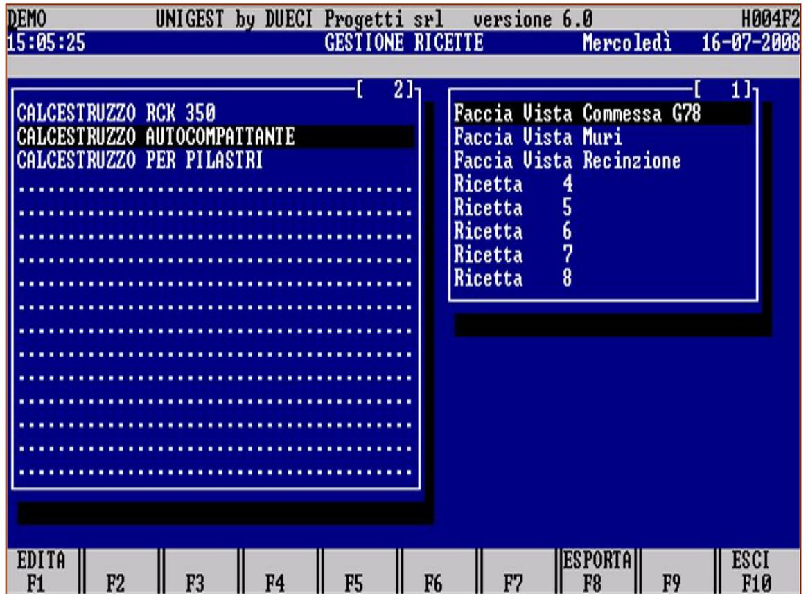
Per ogni componente deve essere impostata la quantità richiesta per ogni tipo di prodotto. Oltre agli inerti ed al cemento, fanno parte della ricetta anche gli additivi, i filler quali cenere volante e calcare, per poter garantire la massima rapidità nel cambio produzione.
