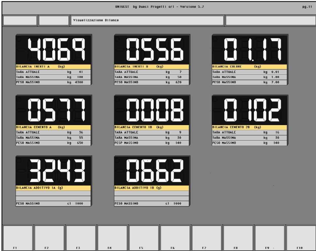
In questa pagina viene visualizzato lo stato delle bilance dell'impianto. E' qui possibile verificare i dati di tara massima e peso massimo impostato, oltreché il valore attualmente letto dalla bilancia.
